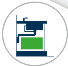
Raccordo salvaspazio per vasche sfalsate e piane Space-saver trap for bowls of the same or different depths
